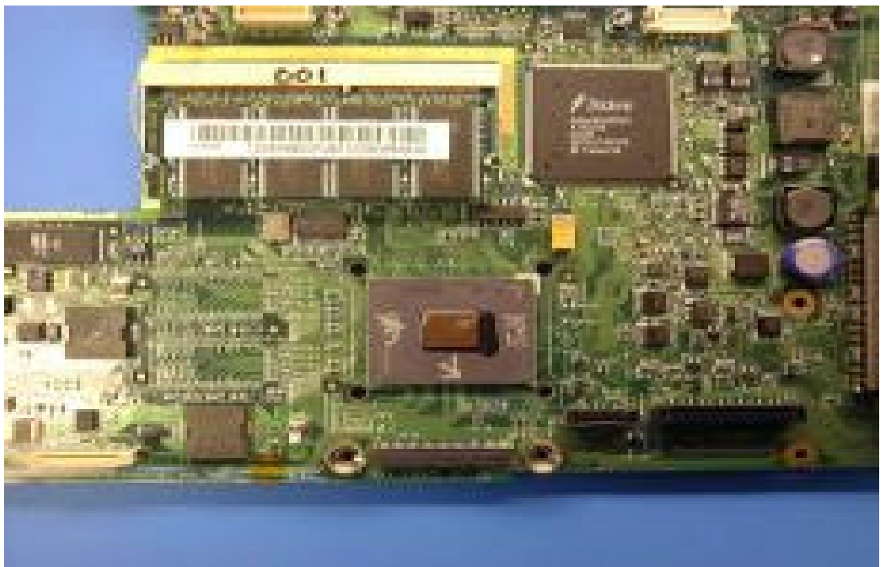
Crusoe na placa mãe (TM5400)
