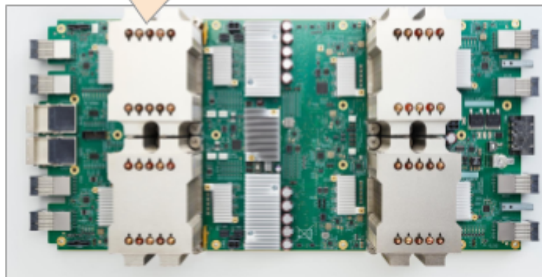
TPU v2 - 4 chips, 2 cores per chip
