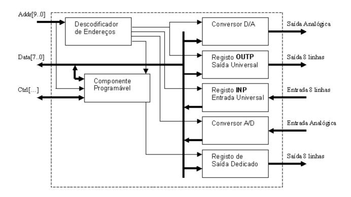
• Os sinais do lado esquerdo são recolhidos do sistema de desenvolvimento CID700 ou da porta paralela. Os sinais do lado direito do diagrama são ligados por cabo ao Painel de Comando.
