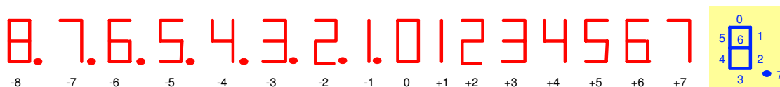
Figura 2: Aspecto gráfico a usar no visor de 8-segmentos, para mostrar o conteúdo da pilha.
