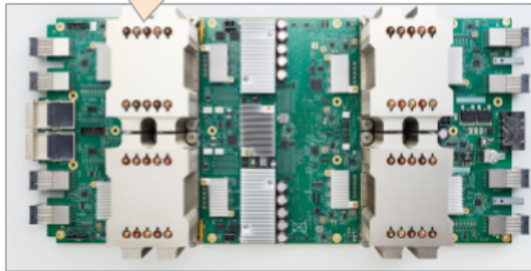
TPU v2 - 4 chips, 2 cores per chip
